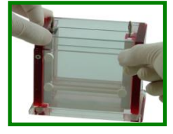
五. 將玻璃片組架上電泳槽，旋緊槽上四個旋鈕。須留意玻璃底部有無氣泡。
