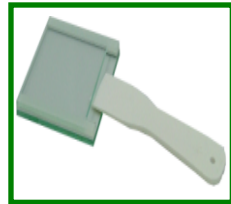
八. 以拆卸把分離玻璃片組，取出膠體進行染色或轉漬。
