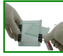
四. 待膠凝完全後，拔掉齒梳與長尾夾。
